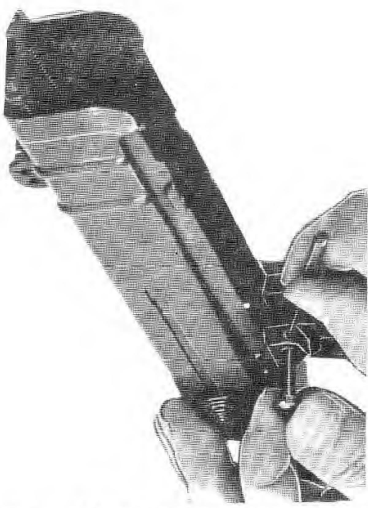
Sl. 56 – Odvajanje vodice zatvarača od usadnika
